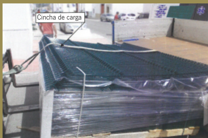
Vallas metálicas que se manipulaban con la carretilla. La eslinga iba del palé a la parte superior de la carretilla.
